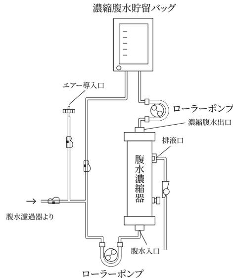
図 1-2 ポンプ式の回路図 (例)
