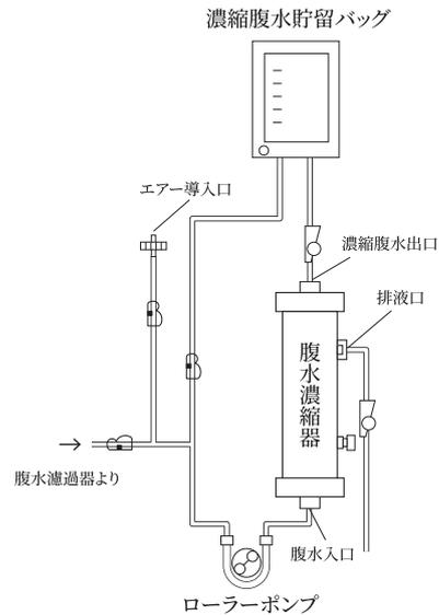
図 1-1 ポンプ式の回路図 (例)
